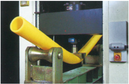
ポリエチレン管の曲げ試験
